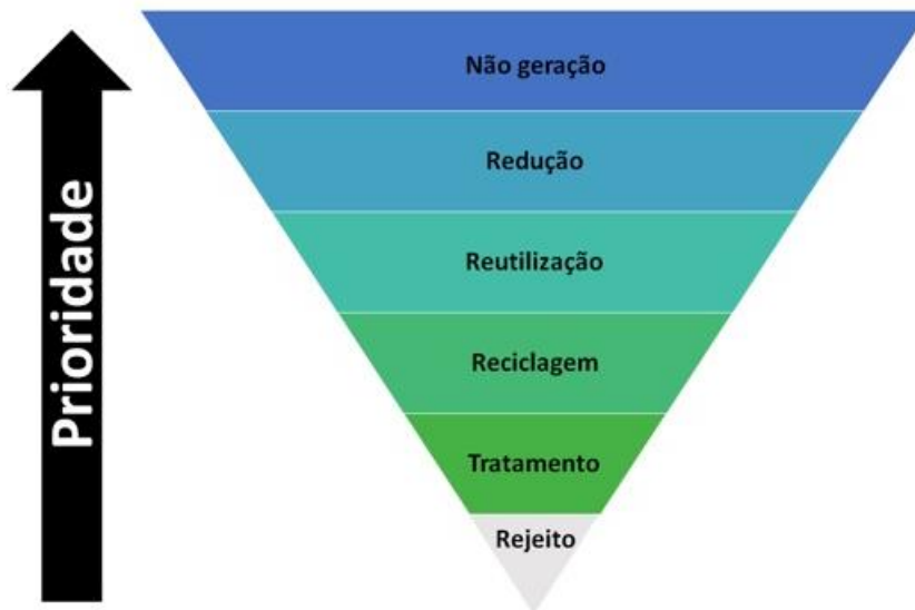
Figura 3. Ordem para a gestão e o gerenciamento dos resíduos sólidos, por prioridade. Fonte: FIESP – Federação das Indústrias do Estado de São Paulo.
